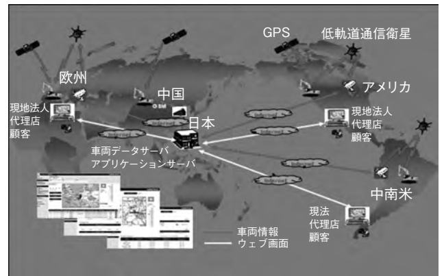
図5 遠隔監視システム構成図
